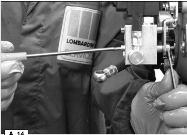
Para quitar el bloque de las electroválvulas desenroscar los dos tornillos de M 5 del estribo de soporte.
